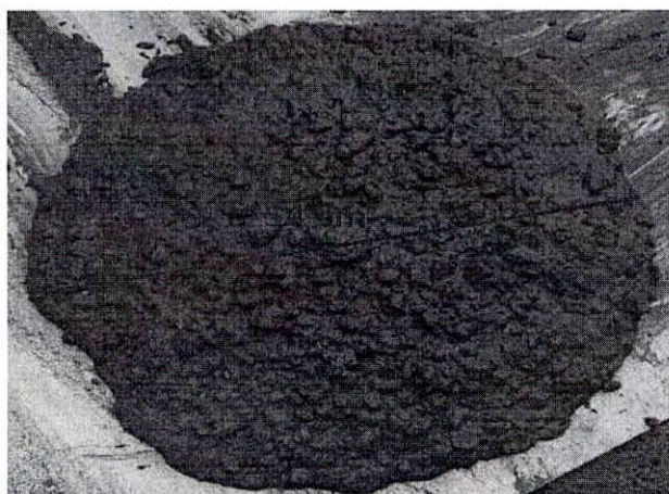
Imagen 003 – Ensayo cono extendido antecedente APPM.
